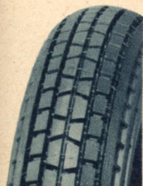
Englebert „Motorrad“ Herkunft vom Rillenreifen unverkennbar, kleine Blöcke, schmale Nuten, lebt lang, verträgt mäßig Dreck.
