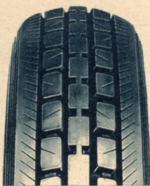
Fulda „Universal“ Straßenreifen, Übergangs- form wie Dunlop „Standard“.
