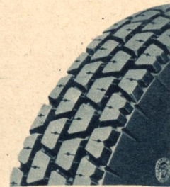
Metzeler „Block C-K“ für Mobile ziemlich „brutales“ Block- profil, hier beginnt bereits Geländebrauchbarkeit.
