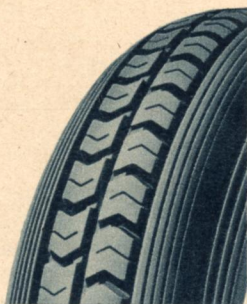
Continental „LB“ aus Rillenreifen entstanden, Straßenreifen, verträgt mäßig Schmiere und Sand.
