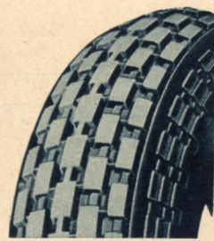
Fulda „Block“ modernes Profil, verträgt viel Dreck, entspricht Dunlop „Grip“.
