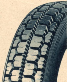
Dunlop „Universal“ sehr modernes Profil, ver- trägt viel Dreck, Randrippen belanglos.
