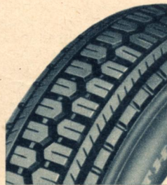
Veith „RF 2“ sehr modernes Profil, ver- trägt viel Dreck, Randrippen durch Fein-Nuten „eni- schärft“.
