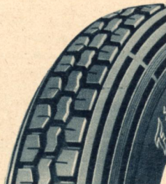
Phoenix Übergangsform, Mittelrille in kleine Blöcke aufgelöst, breite Nuten, verträgt ziem- lich viel Dreck.
